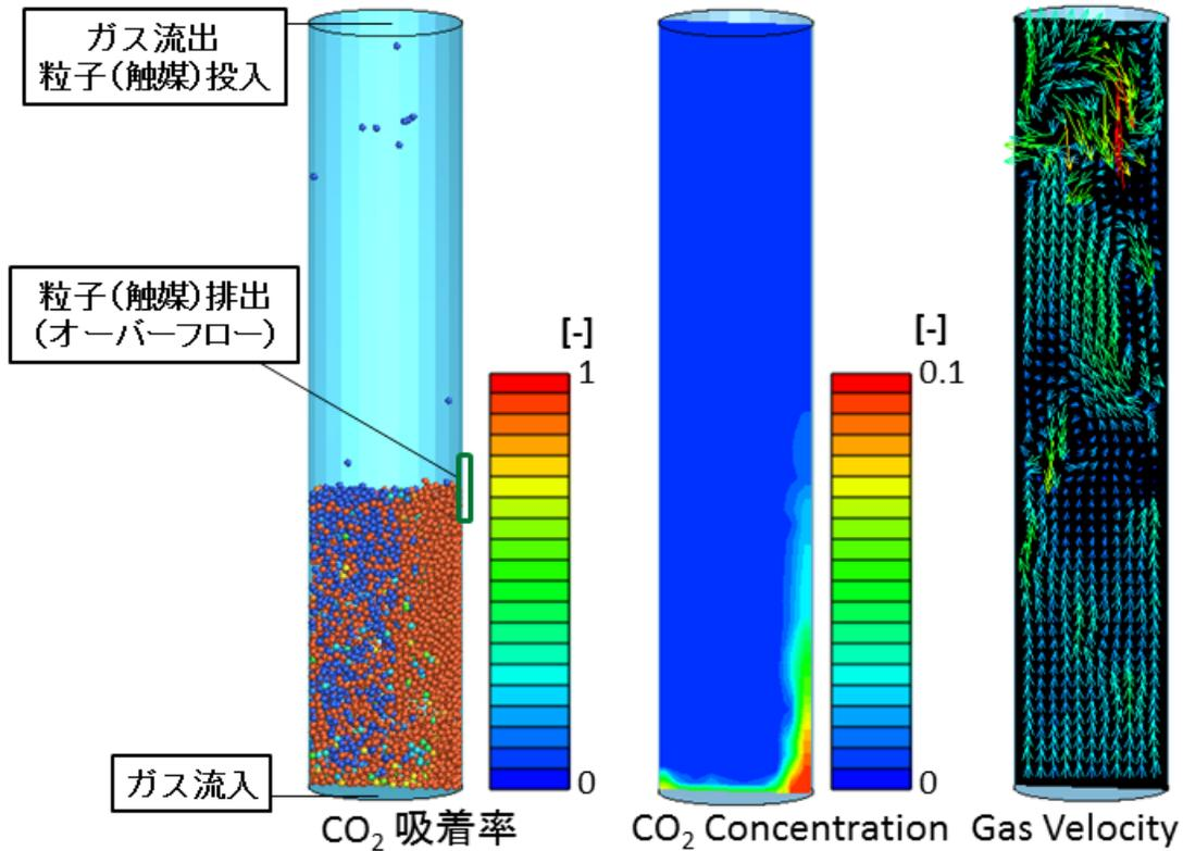
左から、触媒 (Na<sub>2</sub>O) 粒子の二酸化炭素 (CO<sub>2</sub>) 吸着率、ガス中二酸化炭素 (CO<sub>2</sub>) 濃度、ガス流速分布に対応。触媒粒子投入時の CO<sub>2</sub> 吸着率は 0。
